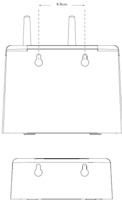
2. Si nécessaire, insérez les chevilles, puis insérez les vis en les laissant ressortir du mur d'environ 5 cm, afin de pouvoir y accrocher le téléphone.
